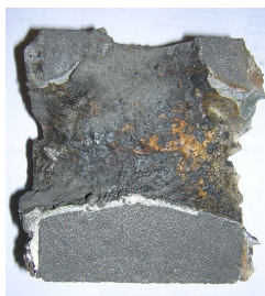
5. ábra A kalciummal kezelt sorozat második szekvensénél használt merülőcső metszete
