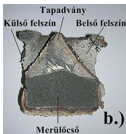
4. ábra Elemzési minták vételi helyei az elvágott (a – új; b – használt) merülőcsövön
