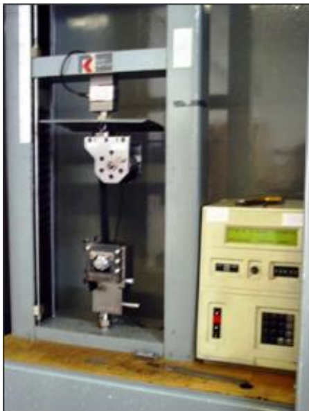
3. ábra A szakító berendezés a befogott darabbal és a szakító diagram
