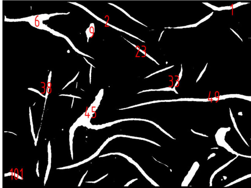
6.20. ábra. Az objektumok azonosítói lemezgrafitos öntöttvas képen.
