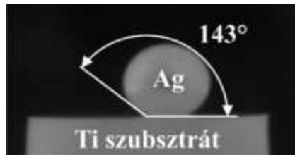
26. ábra. A titán szubsztrát felületén megolvasztott ezüst minta sziluett felvételének peremszögmérése
