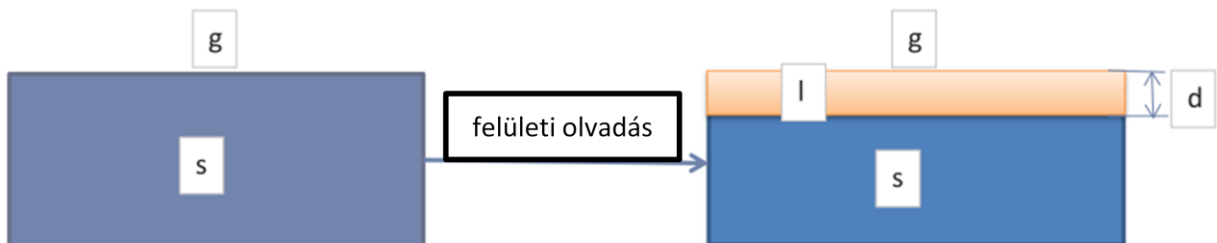
3.1. ábra: A makroszkopikus kristály felületi olvadásának sematikus ábrája [2]
